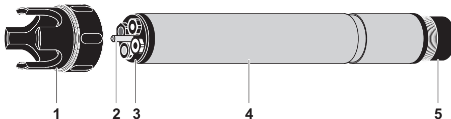
fig. 1-2 Architecture de la sonde VARiON®Plus 700 IQ
